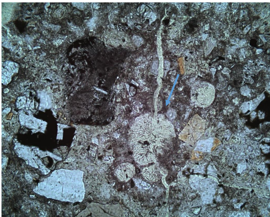
Mynd 29. Yfirborð steypu í neðri fjöruborði stöpsuls 5 í Óseyrarbrú. Útfellingar í loftbólum við yfirborð, sprunga sker loftbóluna, sjá bláu örina. Myndin er 0,49 x 0,67 mm að stærð.
