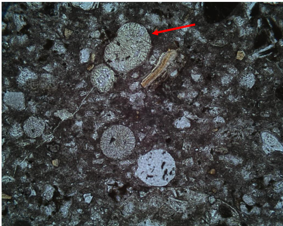
Mynd 28. Yfirborð steypu í neðra fjöruborði stöpsuls 5 í Óseyrarbrú. Útfellingar í loftbólum við yfirborð. Rauða örin bendir á útfellingar í holrými. Myndin er 0,49 x 0,67 mm að stærð.
